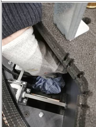
Abb. 36: Pumpensumpf reinigen
