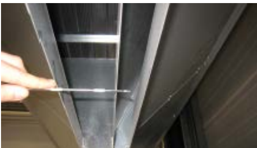
Abbildung 3: Versuchsaufbau im F&E-Centrum der Fa. Kampmann, sowie Darstellung der Austrittsebene, in der vermessen wurde.
