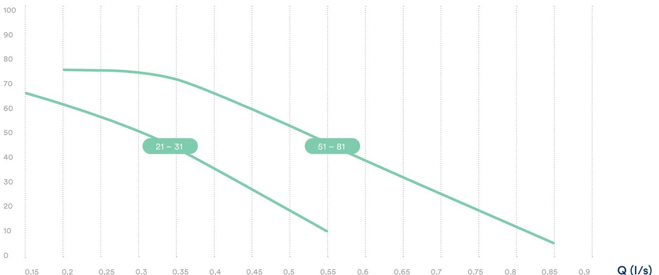
Das Diagramm zeigt die externe Pressung der eingebauten Pumpe. Die internen Druckverluste sind von der Pumpenkennlinie bereits abgezogen. Der Betrieb außerhalb der Kennlinie führt zum Pumpenschaden.
