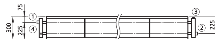
Draufsicht, wechselseitiger Anschluss / Top view, opposite-end connection
