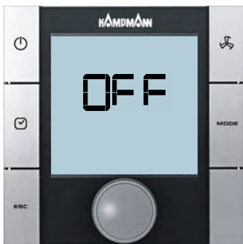
Ansicht Steuerung AUS
