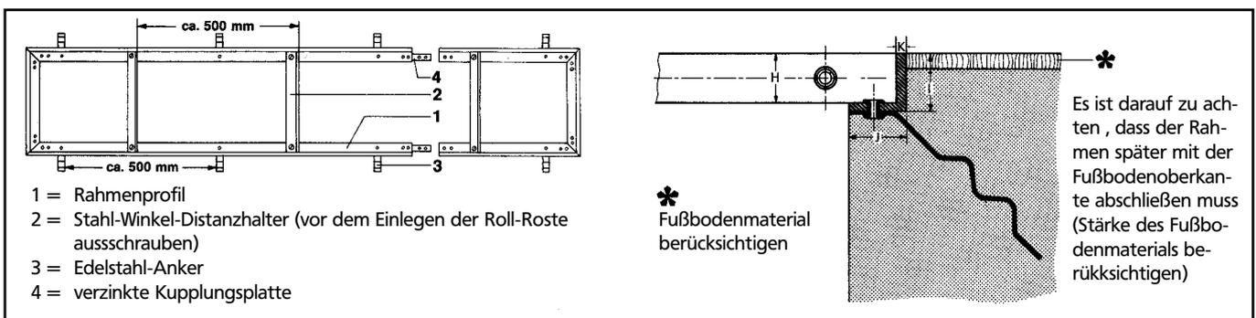
Alle Winkel-Rahmen werden in komplett montiertem Zustand, mit Edelstahl-Ankern und eingeschraubten Stahl-Winkel-Distanzhaltern geliefert. Rahmenlängen über ca. 3 m werden aus Transportgründen geteilt. Die Teilstücke lassen sich durch Kupplungsplatten, die an den Stoßstellen angebracht sind, schnell und einfach zusammenfügen.
