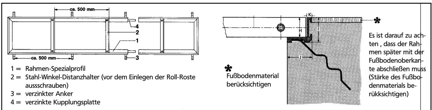
Alle Spezial-Rahmen werden in komplett montiertem Zustand, mit verzinkten Ankern und eingeschraubten Stahl-Winkel-Distanzhaltern geliefert. Rahmenlängen über ca. 3 m werden aus Transportgründen geteilt. Die Teilstücke lassen sich durch Kupplungsplatten, die an den Stoßstellen angebracht sind, schnell und einfach zusammenfügen.
