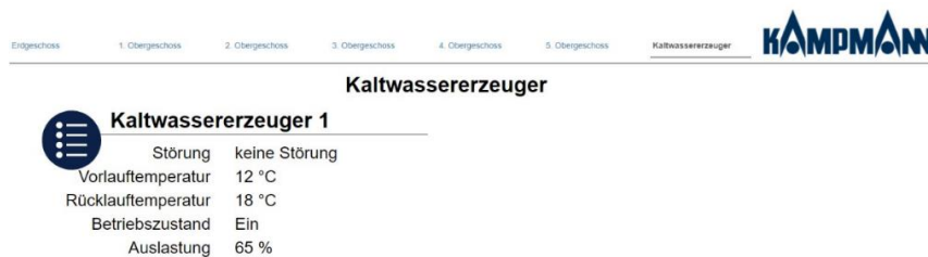
Beispielansicht Kaltwassererzeuger
