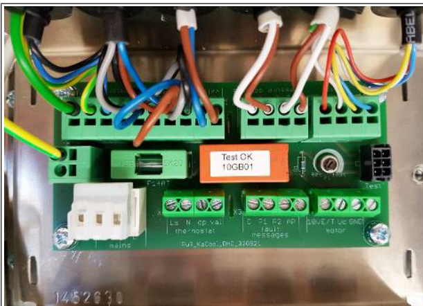
Abb. 12: Platine in Elektroanschlussgehäuse
